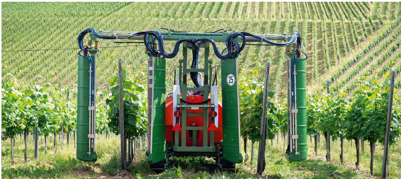
Eine Recyclingspritze spart Spritzbrühe und arbeitet damit besonders ressourcenschonend.
